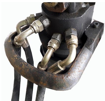
Przylączka węży – obrotnica Liczba węży: 4 szt. Złącze 3/8" dł. = 1100 mm
